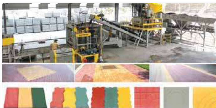
Hệ thống tái chế tro, xi làm vật liệu xây dựng
