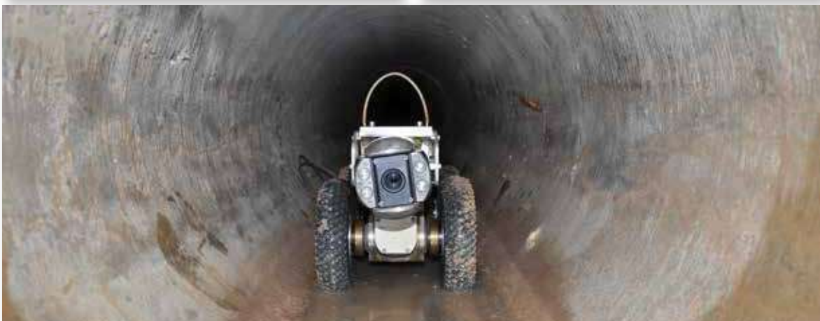
Thiết bị chuyên dùng để kiểm tra bên trong lòng ống
